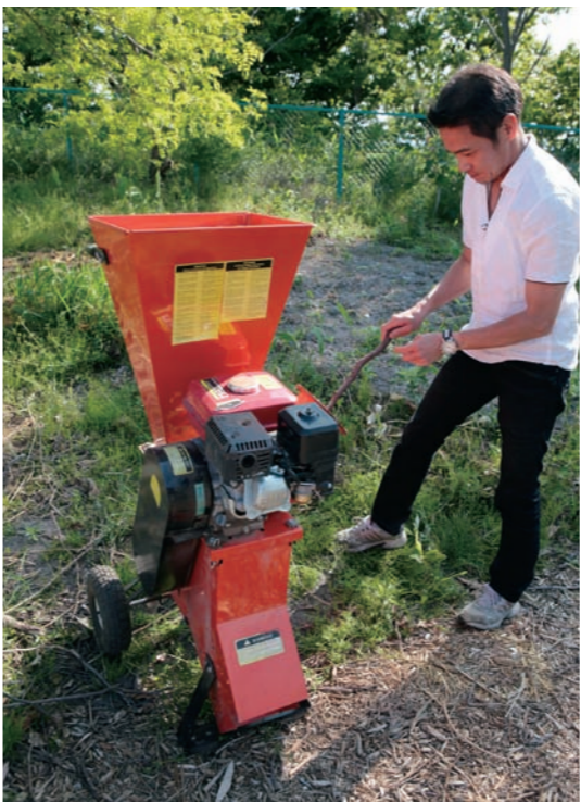
エコビレッジでは伐採した木の枝や使用済みの木材などはウッドチップにして土に返す。写真左は住人が共同で使用することになっているウッドチップ製造用の機械。右側の写真2点は、村の中に通されているウッドチップを敷き詰めた道(左)と家と家の間に作られたホタテ貝殻を埋めて造った側溝(右)。
