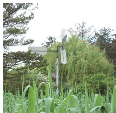
1. 水生植物の葦が生える浄化池は風車ポンプで酸素を供給する
